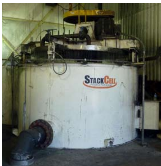
Рис. 13. Фото флотомашин StackCell на действующей обогатительной фабрике в США
