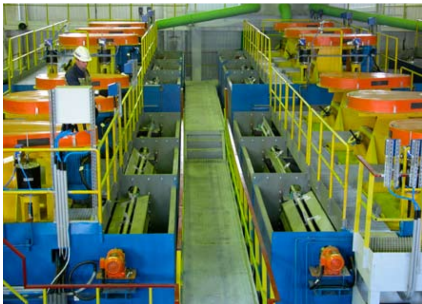
Рис. 1. Камерные механические флотомшины SETCO на новой фабрике в Кузбассе
