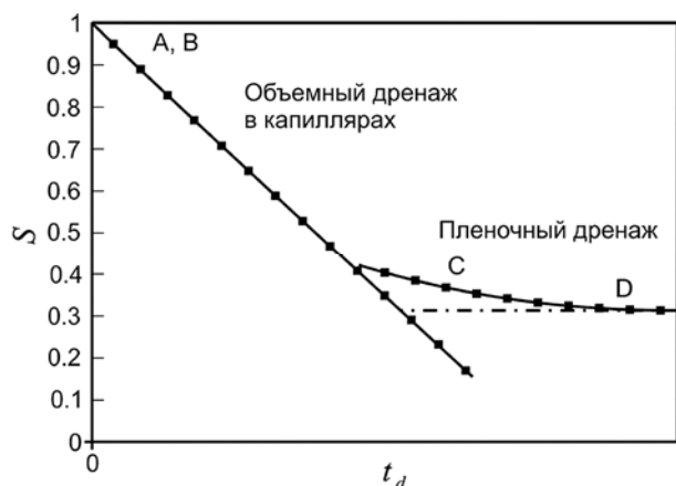
Рис. 5. Объемный и пленочный дренаж в капиллярах осадка
