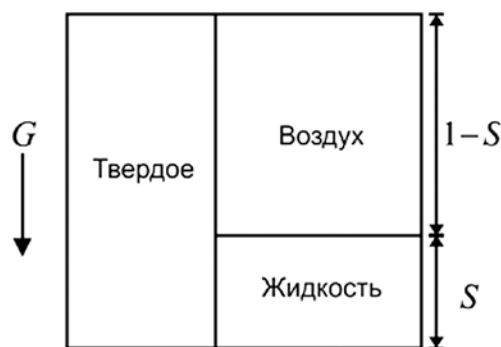
Рис. 1. Схема осадка, условно показывающая соотношение жидкости и воздуха
